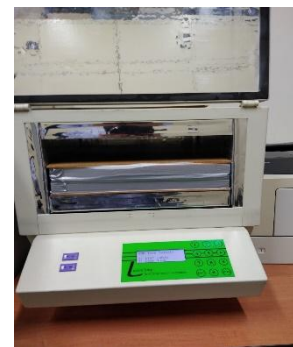
Rysunek 2: Sposób przygotowania izolacji refleksyjnej do badania w aparacie płytowym
