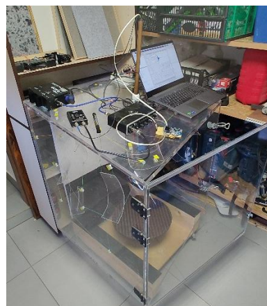
Rysunek 3: Stanowisko pomiarowe do badań rozpraszania dźwięku: widok komory od zewnątrz (z prawej), widok komory od wewnątrz z próbką zamocowaną na stole obrotowym (z lewej) - Stanowisko pomiarowe utworzone na potrzeby realizacji projektu POIR.01.01.01-00-0257/21 pt. „Opracowanie technologii redukcji hałasu na obszarach miejskich w postaci wielofunkcyjnego hybrydowego systemu okładzin zewnętrznych o zmaksymalizowanych funkcjach rozpraszania i pochłaniania dźwięku” finansowanego ze środków finansowanego przez Narodowe Centrum Badań i Rozwoju
