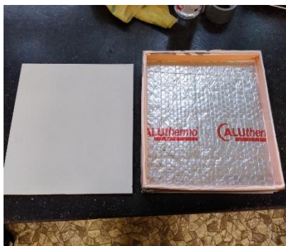
Rysunek 2: Sposób przygotowania izolacji refleksyjnej do badania w aparacie płytowym
