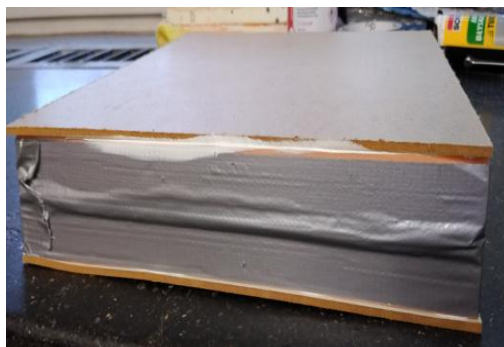
Rysunek 2: Sposób przygotowania izolacji refleksyjnej do badania w aparacie płytowym
